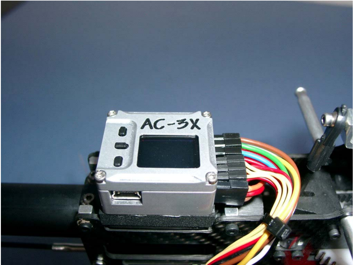
Afbeelding-10: Bevestiging en kabelligging van de AC-3X.
