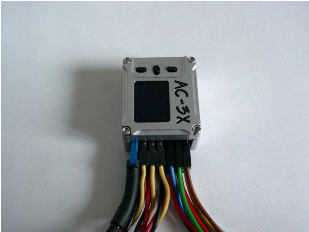
Afbeelding-8: AC-3X met bevestigde aansluitingen en servo kabels.
