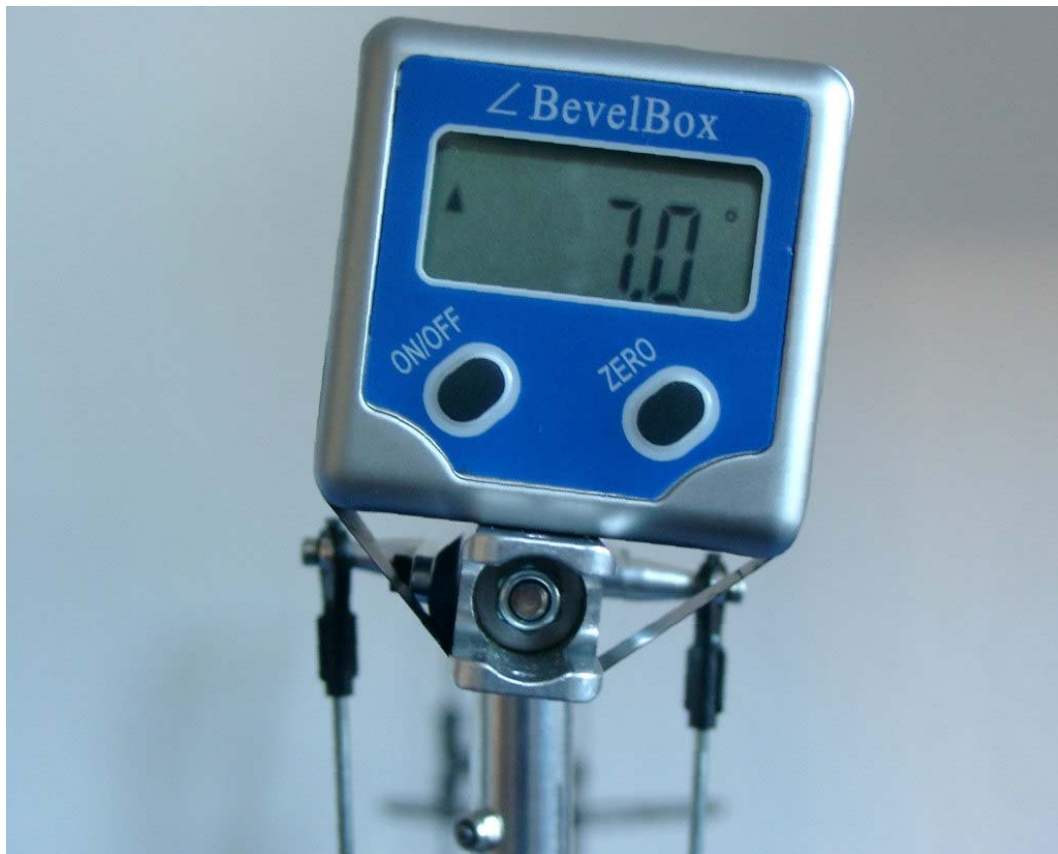
Afbeelding-16: Cyclische volledige uitslag, instelhoek 7 graden.
