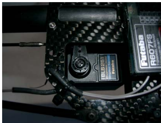
Afbeelding-13: Uitrichten van de Heckservo.
