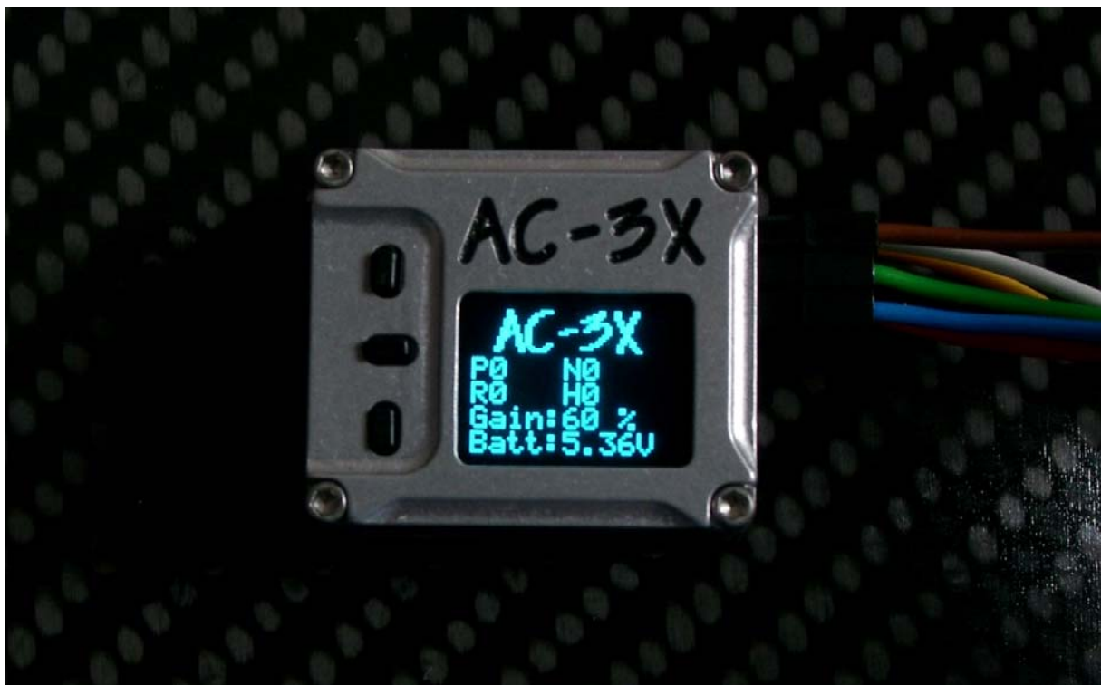
Afbeelding-12: AC-3X ingesteld op 60% via de gevoeligheid instelling.
